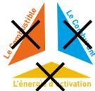
L'extinction par inhibition a pour rôle de bloquer la réaction chimique du feu et de diminuer l'affinité des matériaux ou gaz pour l'air.
